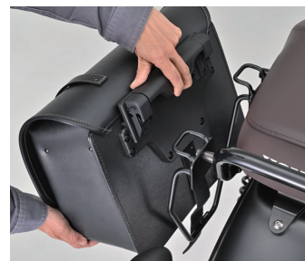
バタつき防止ベルトを外し、ロックを解除。ノブを握って持ち上げるだけで取り外し完了。
